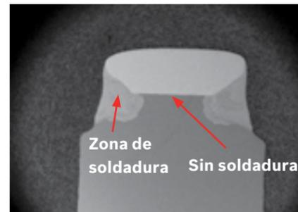
En estos cortes transversales de electrodos, se observa que la soldadura de la bujía Bosch cubre toda la superficie de la plataforma de iridio. En las otras bujías, la zona de soldadura se encuentra sólo en los bordes del metal precioso. Esta soldadura completa permite que el metal precioso tenga la conexión más fuerte posible con el material de base y no se separe aun en las aplicaciones más exigentes.
