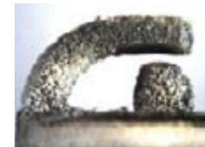
Las bujías están cubiertas de ceniza de aceite. El motor funciona en la forma deseada.
