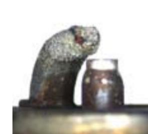
Un electrodo de masa fundido indica preignición. Asegúrese de que el índice térmico de la bujía sea el adecuado y revise la puesta a punto del encendido.
