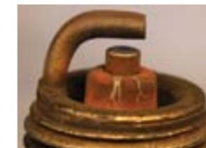
La capa rojiza es hierro. El hierro es conductor y deriva en falsas explosiones cuando la chispa pasa del electrodo central a la carcasa, en vez de saltar entre los electrodos (observe las líneas blancas en la cerámica). El motor no funciona en la forma deseada. Puede que las válvulas no estén asentadas correctamente.
