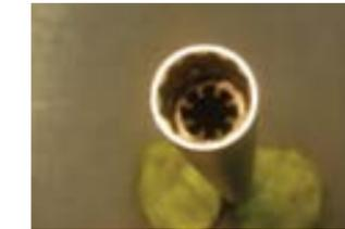
Durante la colocación y extracción, si el receptáculo no queda totalmente asentado en la bujía o si se aplica en ángulo, la fuerza lateral puede generar grietas en la cerámica ubicada entre la
