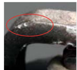
La bujía se dañó durante la instalación o recibió algún impacto durante el uso. Sea cauteloso al instalar nuevas bujías. Tenga cuidado de que no se le caigan las bujías en la tapa del cilindro durante la instalación.
