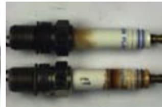
Las bujías M18 se deben ajustar con un torque de 35-45 Nm (26-33 lb-pie)
