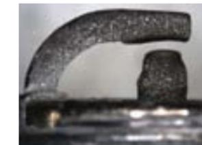
El motor funciona en la forma deseada, pero las bujías alcanzaron el final de su vida útil. Reemplace las bujías.
