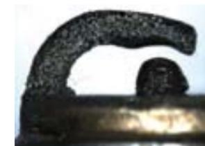
Las bujías están recubiertas de aceite, lo que indica un alto consumo de aceite. Podría derivar en una falla de la bujía, por ejemplo, agrietamiento del aislante o contaminación del aceite, con la consecuente dificultad para arrancar.
